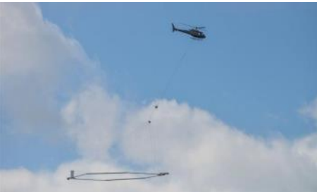
Det er danske Skytem, der har udviklet den antenne, der fragtes rundt under en helikopter. Illustration: Skytem, Bo Bjerre.
