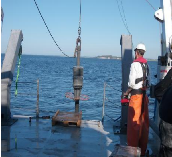
Inde i det tunge stålrør, som ses på billedet her, findes et plastikrør, som fyldes med sedimenter, når røret sænkes ned. Plastikrøret trækker forskerne ud og begynder at undersøge, når de hejser det tilbage op på skibet. (Foto: Niels Nørgaard-Pedersen)
