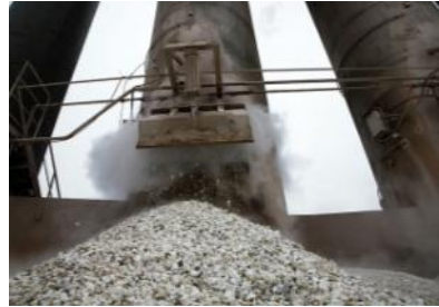
Efter at være opvarmet til en temperatur på 1150-1200 grader tømmer den nu hvide flint ud af højovnen.
