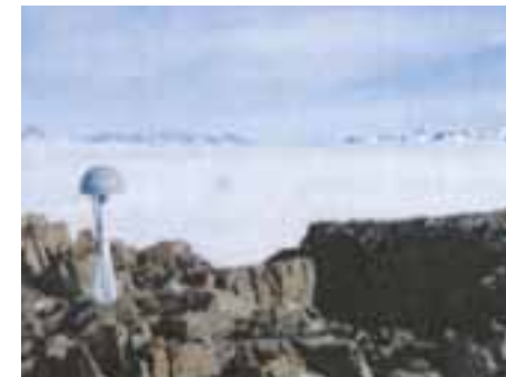
Billedet viser en GPS-station med sender (kuplen), der drives af solenergi.
