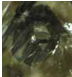
Under overfladen på denne diamant ses et korn af jernsulfid, omgivet af en mørk rand. (Foto: Jeffrey Harris, University of Glasgow)
